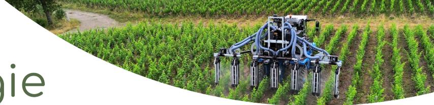
Les descentes de pulvérisation face par face BLISS permettent une qualité d'application optimale et une réduction de la dérive inégalée. Cette technologie unique focalise la pulvérisation sur le feuillage et la guide jusqu'au cœur de la végétation.
