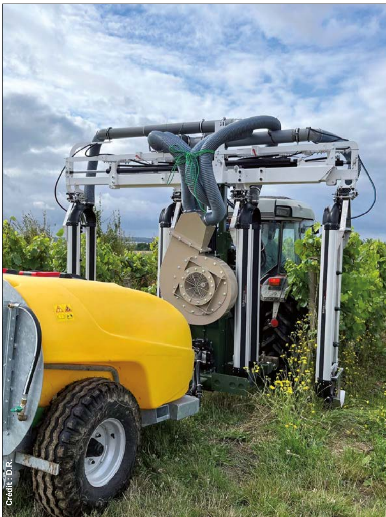
Une diminution de la dérive homologuée à 95% grâce aux descentes de pulvérisation en usage face par face.
