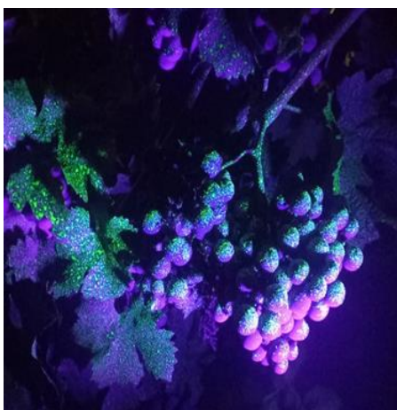
Figure 5 : Photos de grappes pulvérisées à la fluorescéine avec le pulvérisateur Bliss (1)
