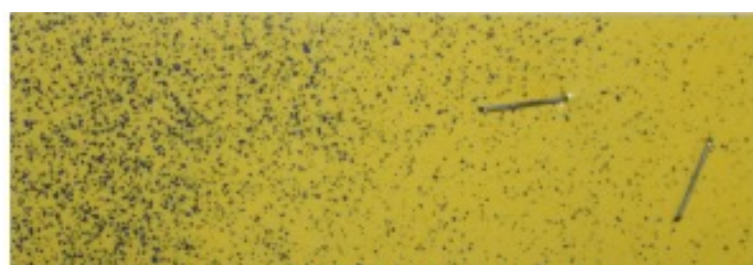
Figure 4 : PHS face inférieure Buse à turbulence (cône creux) ALBUZ ATI 80-0050 Lilas 5.5bar
